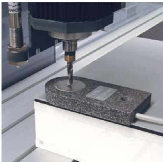
z-Justiereinheit im Moment der Vermessung zwischen Werkzeugspitze und Werkstückoberfläche
