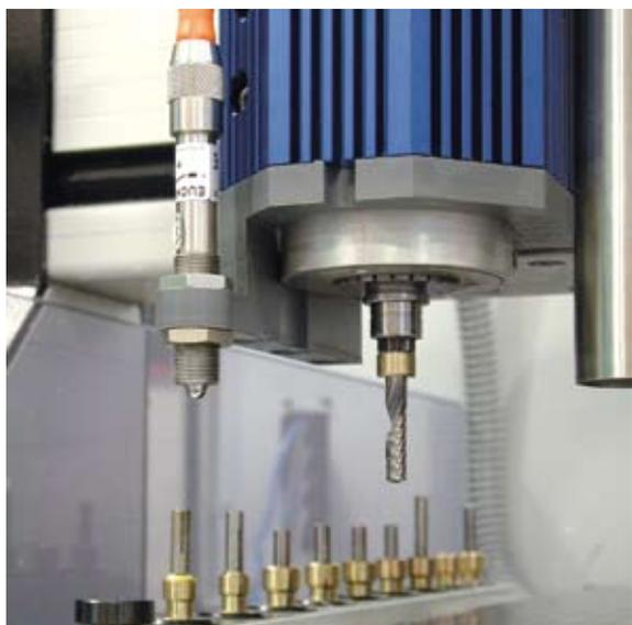
Werkstücknivellierung (links von der Spindel montiert)
