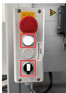
Abb. 26 BEDIENELEMENT MIT NOT-HALT- UND QUITTIERUNGSTASTER
