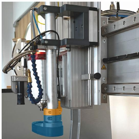
Abb. 24 ELEKTRONISCH ÜBERWACHTER SAUGSCHUH
