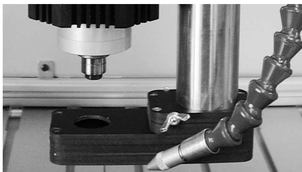
*[Abbildung: Staubabsaugung, hier mit Kühl-/Sprühvorrichtung im Vordergrund]*
