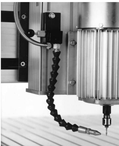
*[Abbildung: Kühl- und Sprühvorrichtung]*
