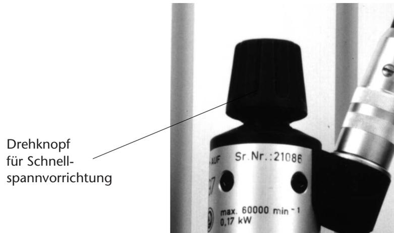
[Abbildung: Schnellspannvorrichtung an der SF 170]
