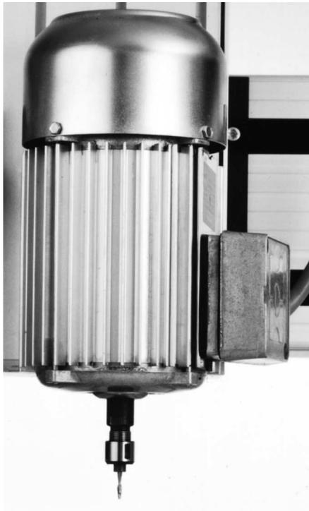
*[Abbildung: Drehstromspindel SPC 650 montiert auf z-Achse]*
