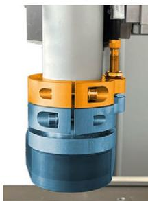
ABB. 16 ELEKTRONISCH ÜBERWACHTER SAUGSCHUH
