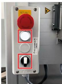
ABB. 17 BEDIENELEMENT MIT NOT-HALT- UND QUIITTIERUNGSTASTER
