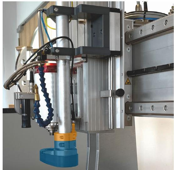
Abb. 25 ELEKTRONISCH ÜBERWACHTER SAUGSCHUH
