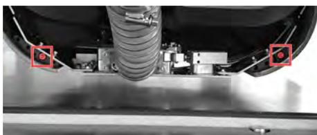
FIG. 73 SCREWS ON THE BACK OF THE HOOD
