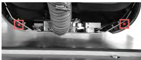
FIG. 78 SCREWS ON THE BACK OF THE HOOD
