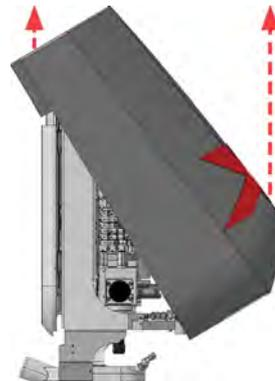
FIG. 75 LIFTING OFF THE HOOD
